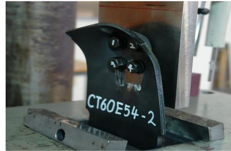
그림 5. 면외변형 발생모습 ( $t_e=6.0$ mm,  $e=54$ mm)
