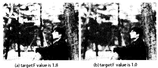
그림 11 조리개값을 F1.8 (a)과 F1.0 (b)로 세팅하여 계산된 결과 이미지. 사용된 카메라의 렌즈는 F2.8이 최대 개방 조리개이므로 F1.8과 F1.0은 실제로는 얻을 수 없다. (Jeong 등[14]에서 발췌)
