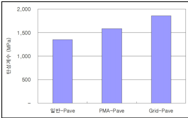
그림 6. 역산해석을 통한 아스콘층의 탄성계수
