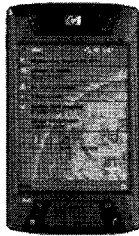
그림 6. 실험에 사용한 RSU(Linksys WRT-54G)와 OBU(HP HX-4700)
