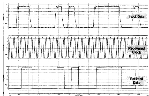
그림 11. CDR의 시뮬레이션 결과 (a) 2^7-1 입력 PRBS (b) 생성된 클럭 신호 (c) 복원된 데이터 Fig. 11. Simulation results of CDR (a) Input 2^7-1 PRBS (b) recovered clock (c) retimed data
