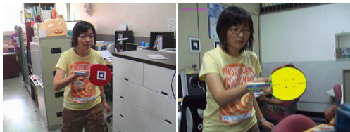
[그림 7] 라켓 표면에 부착된 마커를 검출하여 실시간 라켓 위치를 추정하는 기법의 적용
