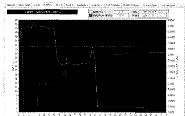
그림 6. 에너지 과금이 피크일 때 소비 전력 측정. Fig. 6. Check of watt when peak time of energy price.
