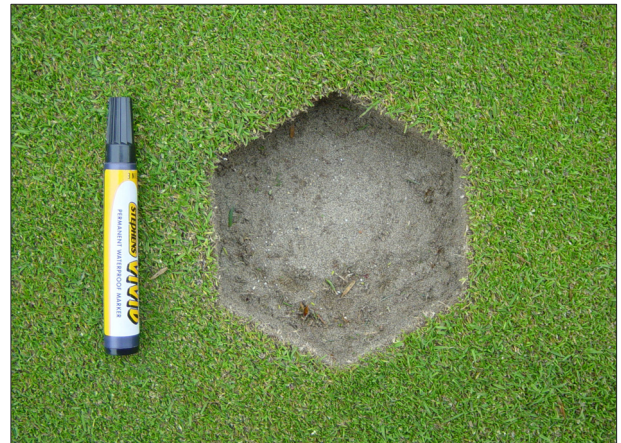
그림 2. 최상부 토양 표면으로부터 토심 5cm 토양층을 제거함으로 하부 토양층의 통기성을 개선한 실험구: 처리 2 자료: 필자 촬영
