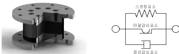
〈그림 2〉 고감쇠 고무받침 형상 및 기계적 특성
