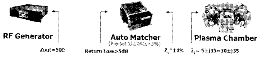
(a) 플라즈마 챔버의 동작을 위한 기본 구성도 (a) Basic schematic for operation of plasma chamber
