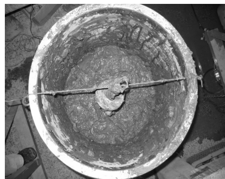
(a) PBD의 중앙부 설치
