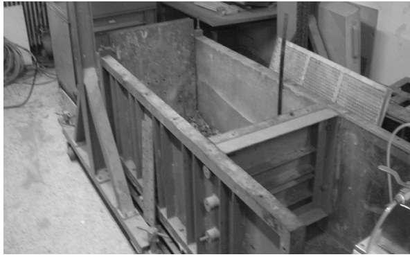
(a) 모형 토조 전경 및 하부지반조성
