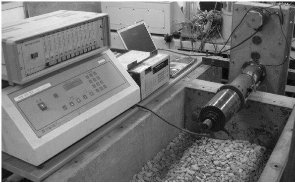
(c) 하중재하 장치 설치
