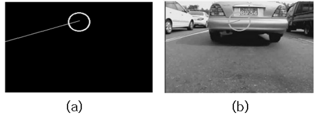
(그림 16) 제안한 차선이탈 알고리즘을 적용한 결과
