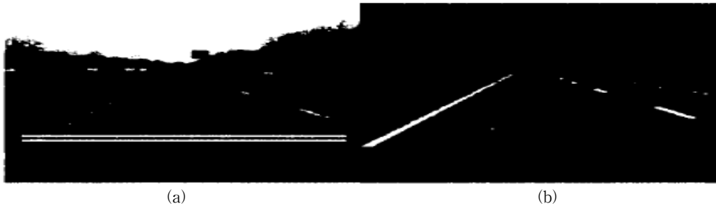
(그림 2) (a) 원본영상과 설정된 밴드 모습, (b) thresholding과 merging 후 영상
