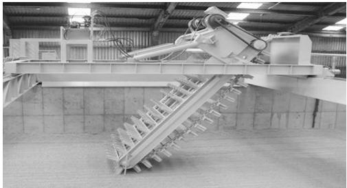
강남시스템(대표 김태환)은 유기성폐기물을 발효조의 퇴비단을 파쇄하는 장치인 ‘퇴비단 자동파쇄장치’를 선보인다. 종래의 발효교반차는 미교반지역이 발생하며 단단하게 뭉친 퇴비더미를 잘 파쇄시키지 못해 부하가 심하게 걸려서 잣은 고장의 원인이 되며 유지보수비가 과다하게 소요되는 문제점이 있었다. 이번에 개발된 ‘퇴비단 자동파쇄장치’는 양쪽 퇴비단 파쇄날개가 퇴비더미를 넓은 폭으로 먼저 파고 들어가 교반지역의 퇴비더미가 쉽게 무너지도록 파쇄 시켜줌으로써 미교반 지역이 발생되지 않고 교반작업 속도가 향상되어 생산성을 높일 수 있다고 전한다. 그리고 에스컬레이터 및 이동대차에 동력을 부여하는 전동기와 감속구동부 및 동력 전달계통의 부품들이 과부하로 인해 쉽게 고장나는 것을 방지할 수 있으므로 발효교반차의 유지보수비용을 상당히 줄
