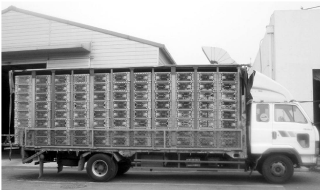
▲국내 도계장에서는 유일하게 크레이트 상자를 이용해 수송. 사계와 멩계 최소화와 수송 중 비위생적인 닭차 이미지 탈피
