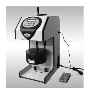
고주파 실링기는 전자유도가열을 이용하여 HDPE, PP, PET, PS, ABS 등 각종 플라스틱, 유리, 종이, 금속, 도자기 등의 용기에 내용물 충진 후 입구를 전도성 재질이 포함된 알루미늄 실링지를 사용하여 밀봉시키는 목적으로 포장의 완성도에 기여하는 제품이다. 자체개발한 내부적 특허기술과 차별화된 심미적인 디자인을 외형부에 접목했으며 주파수 20khz대 출력장치 적용으로 코일 생산 효율성 극대화 및 비용절감실현했다.
