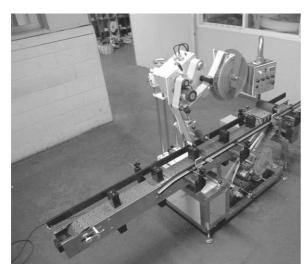
기존의 2개 묶음의 찰떡쿠기박스를 3개 묶음으로 생산 변경함에 있어서 기존 설비 자체는 그대로 사용하면서 6명이 부착하던 라벨링 작업을 기계 한 대로 1분에 40여개 생산 할수 있는 장비이다. 크기 등 제품마다 제각기 다른 제품의 제원에 부착물의 변경없이 1대의 기계만으로 여러 제품을 주문자가 원하는대로 부착기능한 제품이다.
