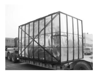
조립식 스틸박스는 기존의 목상자에 비해 최소비용으로 포장재료의 강도를 극대화하고. 제품고정 및 체결방식을 달리함에 따라 JIG 및 Bolt를 이용한 고정, 포장조립 및 해체작업이 용이하다.
