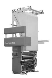
각 인쇄 유닛의 판동마다 개별 모터를 장착하여 독립적으로 구동되는 동시에, 이웃한 유닛의 판동과의 위상각(phase angle)을 조절하도록 연동되어 인쇄 이송방향으로의 핀트(registration)를 보정하는 시스템이다.
