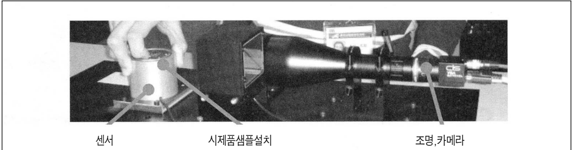
[사진 2] 손가락 부하계측 장치
