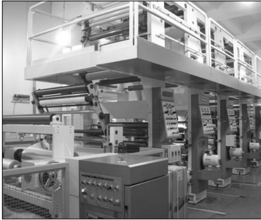
[그림 2] 3도 그라비아 인쇄기(FDRC 개발, 건국대)
