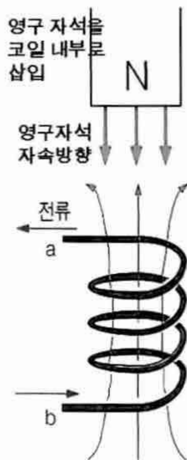
[그림 8] 들어오는 자속을 막으려는 역방향 자속 발생(렌츠의 법칙)
