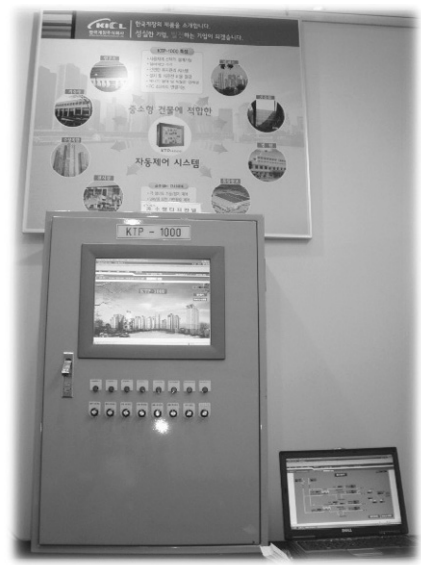
▲ 환경플랜트 자동제어 통합관리 시스템 중 하나인 터치판넬
