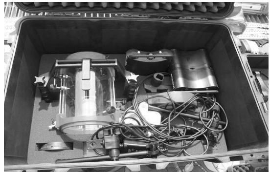
〈사진 8〉 비디오카메라(하우징, 수중라이트)
