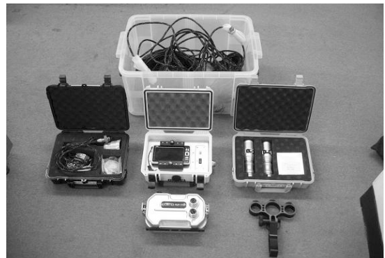
〈사진 9〉 CCTV 카메라 및 콘트롤BOX
