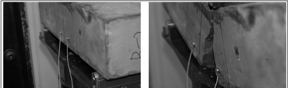
그림 8. Bending test(rectangle) sample before and after failure
