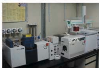
유지문기법에 사용되는 최신 가스크로마토그래피 장비
