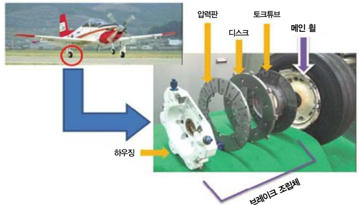
KT-1 메인 휠(Main Wheel) / 브레이크 조립체 (Brake Ass'y)
