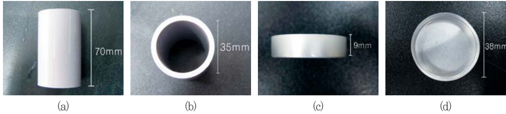
Figure 10. 공시체 몰드 규격. (a) 강도 측정용 공시체 몰드 높이, (b) 강도 측정용 공시체 몰드 내경, (c) 표면관찰용 공시체 몰드 높이, (d) 표면관찰용 공시체 몰드 내경.
