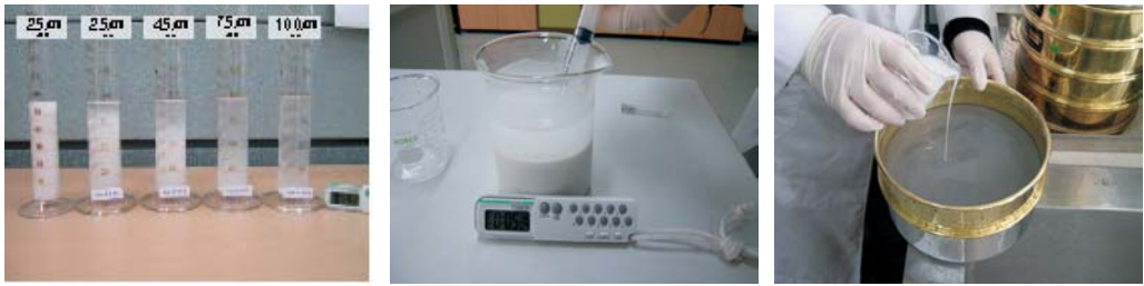
(a) 입자크기별 수중 낙하속도 측정 (b) 5분후 현탁액의 상등액을 취함 (c) 25 \mu m 체를 모두 통과하는 상등액
