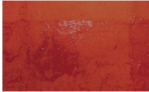
Figure 22. Sample 1-2-b 표면 미세균열 및 광택
