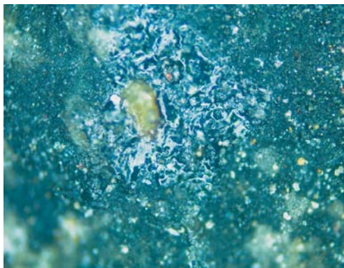
Figure 5. Sample 4 표면 수지도포 부분(×100)
