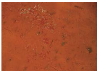
Figure 17. Sample 1 수지도포 후 표면상태(×50)
