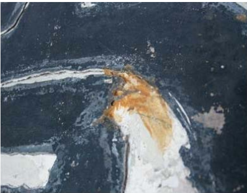
Figure 6. 접착제로 오염된 상태
