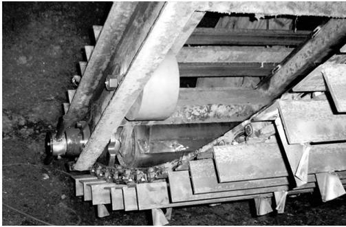
강남시스템(대표 김태환)은 발효교반대차의 에스컬레이터 장치를 고안했다. 종래의 에스컬레이터 장치는 교반앵글의 양쪽에 설치된 체인이 순환 회전될 때의 마찰 소음이 심하고, 교반 앵글의 틈새로 떨어져 쌓이는 교반물로 인해 고장이 잦아 수시로 청소하여야 하며, 체인을 받쳐주는 철제 받침판이 부식되므로 그 때마다 가동 중지 및 부품교체로 인해 생산성이 저하되어 원가상승의 요인이 되었다. 이에 발효교반대차의 에스컬레이터 장치를 구성함에 있어서, 양쪽 프레임에는 일렬로 다수의 체결공을 형성하고, 각 체결공에는 베어링에 의해 공회전 되는 받침롤러를 체인이 받쳐질 수 있도록 양쪽프레임의 안쪽 면에서 설치하고, 샤프트의 체결부는 양쪽 프레임의 바깥 면에 위치되게 설치한 것으로써, 양쪽 체인을 다수의 받침롤러들이 받쳐주어서 작동소음이 현저히 감소되므로 작업환경이 개선되
