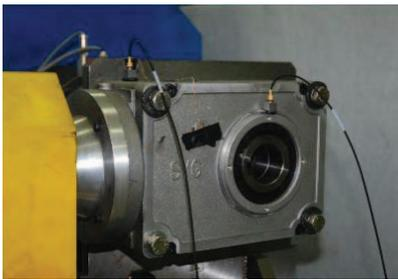
그림 13. 하이포이드 감속기의 진동 측정
