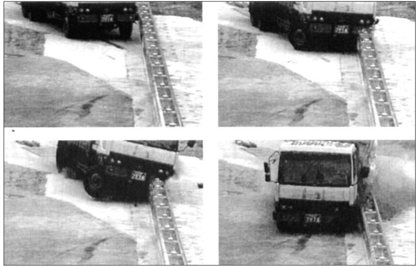
강도성능 충돌시험 - 충돌조건 : 차체중량 14ton, 충돌속도 65km/h, 충돌각도 15°
