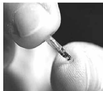
〈생체 주입형 RFID 마이크로칩 예시〉
