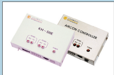
▶RCU KHCM의 최대전력관리장치 명령어와 관련 Parameter값을 받아들여 분석, 제어, 모니터링 하는 장치
