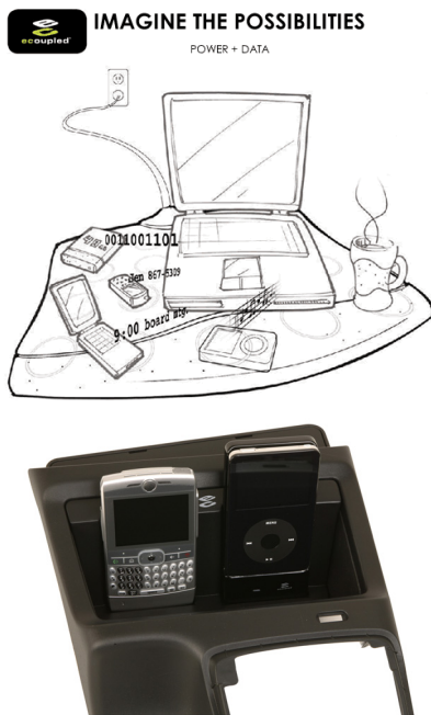
(그림 12) Foulton의 “eCoupled”. 위의 그림은 한 장의 패드에 다양한 기기를 올려 놓고 충전할 수 있다는 제품의 개념도이고, 아래는 자동차의 콘솔 박스에 장착하여 여러 휴대기기를 충전하도록 하는 제품 사진이다.
