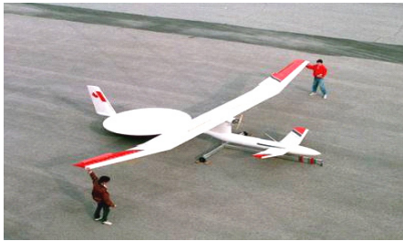
(그림 6) SHARP라는 이름으로 알려진 무선전력전송을 이용한 무인 비행기. 비행기 후방의 디스크 모양은 Rectenna로서 지상의 Microwave Antenna Array에서 공급된 에너지를 DC로 변환하는 장치이다.
