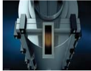
그림 2-a) 초고랄스키 법에 의한 단결정 성장 장치.bmp
