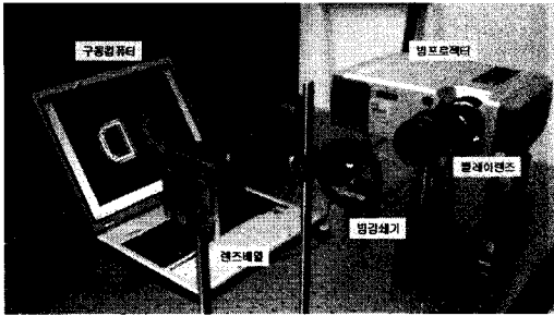
그림 7. 3D 집적 영상 시스템의 광학적 구성도
