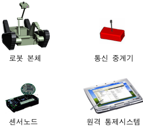
[그림 3] 이동용 경계 및 감시로봇 주요 구성품
