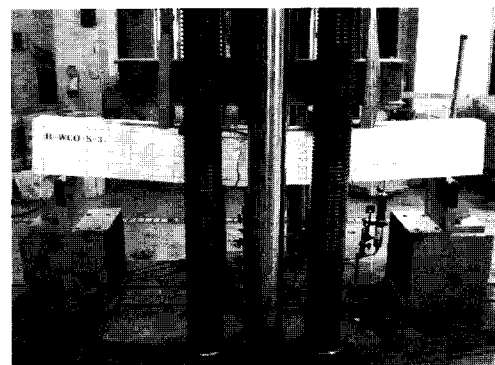
사진 1. 부재시험체 힘실험 전경
