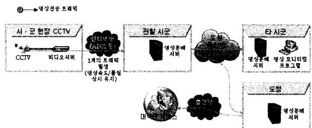
그림 5. 영상분배서버를 통한 네트워크 트래픽 분산과정 Fig. 5. Resolving bandwidth problem by the server.
