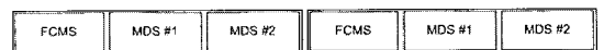
<그림 8> 2대 차량에게 100바이트 전송시 프레임 구조 <Fig. 8> Frame of 2 vehicles for 100 bytes transmission
