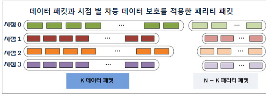
그림 3. 시점 우선순위에 따른 전송계층의 차등 데이터 보호 Fig. 3. Unequal Error Protection in Transport Layer with View Priority
