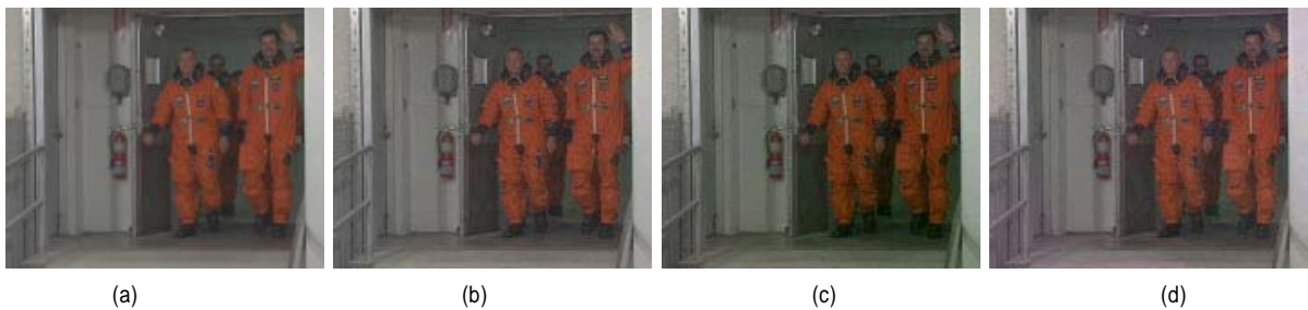
그림 10. Crew영상에서의 화질 비교, (a) 원 영상을 1/16크기로 축소한 영상, (b) QP 21에서 SD방법으로 추출한 영상 (c) QP 21에서의 TD방법으로 추출한 영상 (d) QP 21에서 TDEC방법으로 추출한 영상 Figure 10. Subjective quality performance of Crew sequence. (a) 1/16 size image (176x144) (b) Thumbnail extracted from SD method in QP 21 (c) Thumbnail extracted from TD method in QP 21 (d) Thumbnail extracted from TDEC method in QP 21
