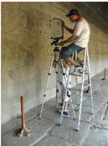
▶▶ 그림 10. 앙코르와트 벽면에 부조된 비쉬누 신상(神像)을 3D 스캔하고 있는 모습(위)과 그 결과 데이터(아래)
