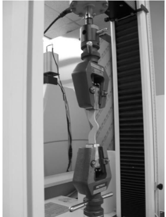
그림 3. Tear strength test
