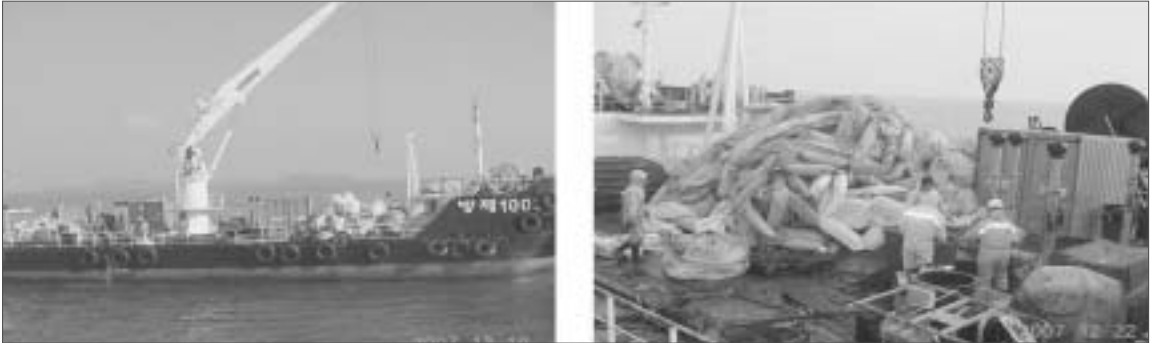
〈그림 9〉 해상 저장바지에 회수유의 이송과 폐기물의 이적작업
