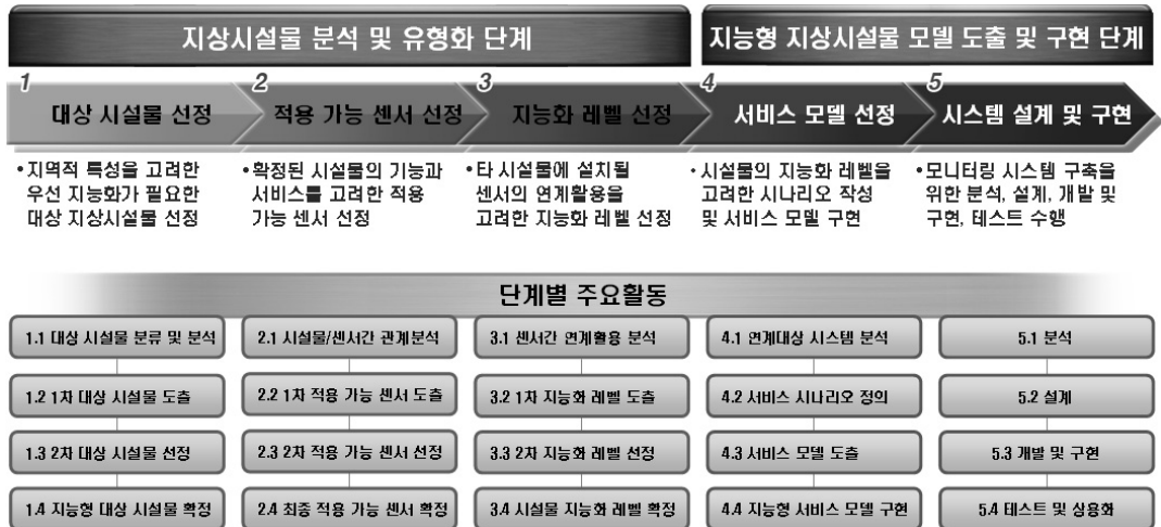
그림 3. USN 기반 지상시설물 통합관리 서비스 구현절차(안)
