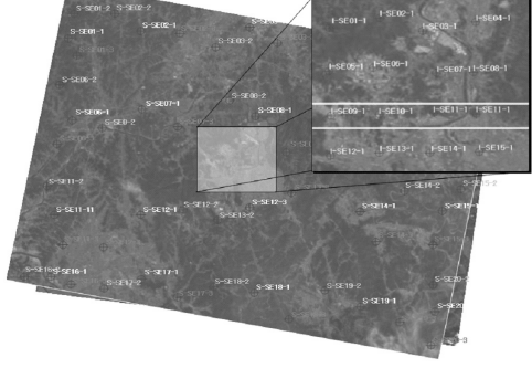
그림 12. SPOT-5+IKONOS 입체 영상칩을 활용한 신규위성영상의 기준점 배치현황
