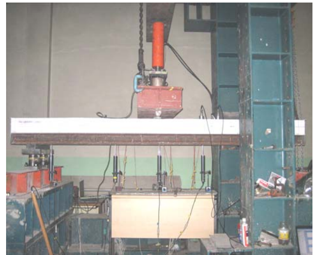
그림 3. 실험체 셋팅 현황 (LVDT, 가속도계 등)
