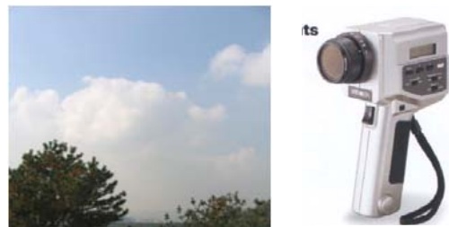
(a) 외부천공 (b) CS-100 그림 17. 휘도측정시 옥외 천공 상태와 측정 장비
