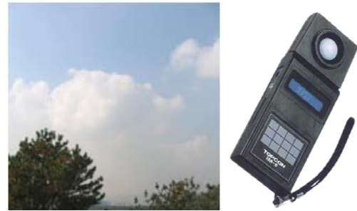
(a) 천공 (b) IM-5 그림 11. 조도측정시 천공 상태와 측정 장비
