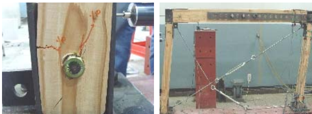
(a) 볼트주변의 균열
