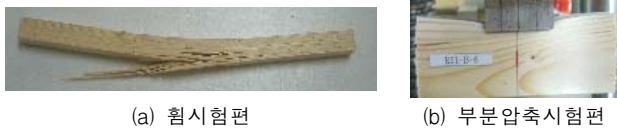
(a) 휨시험편 (b) 부분압축시험편 그림 6. 시험편 형태
